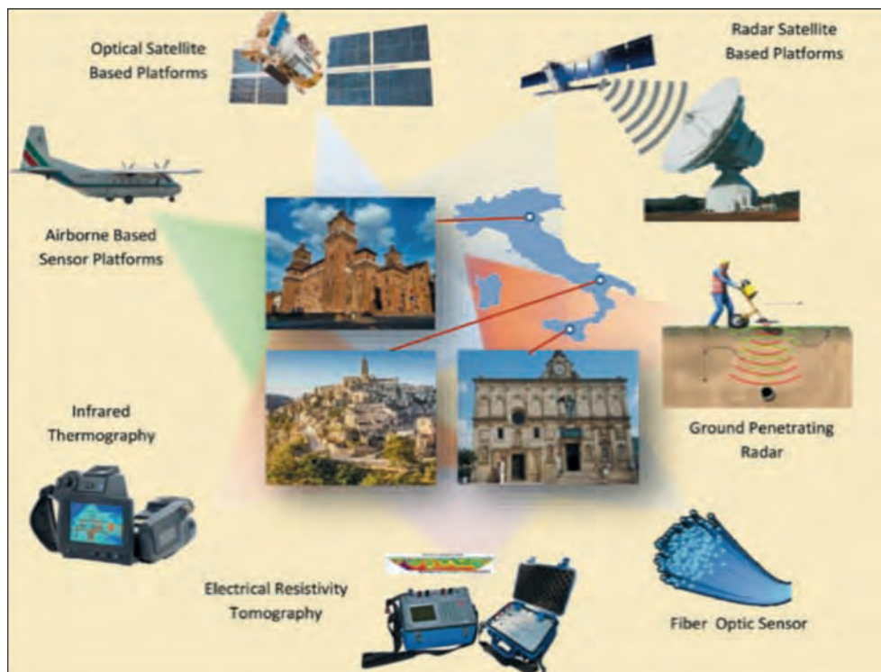
Fig. 3 - Schema semplificato dell'approccio adottato dal progetto CLARA che si basa sull'integrazione di un ampio spettro di metodologie osservative e sensoristica avanzata per il monitoraggio delle aree urbane.
