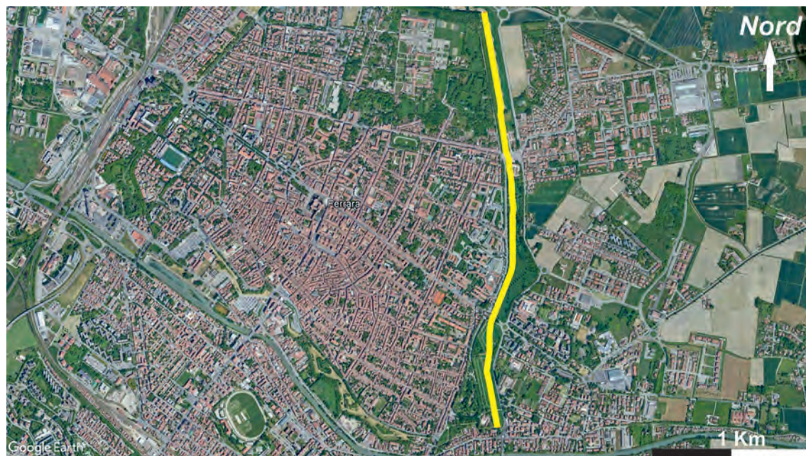
Fig. 1 - Linea sismica onde P effettuata lungo il fossato delle mura orientali della città di Ferrara.
