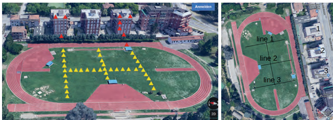
Fig. 1 - Set-up dell'esperimento sull'interazione suolo-struttura effettuato a Ferrara. I triangoli rossi rappresentano i sensori sismici che sono stati installati nell'edificio, i triangoli gialli quelli che sono stati installati sul campo di atletica.
