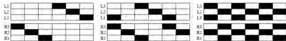
Fig. 3 - Schemi di tre diverse andature periodiche degli esapodi.
