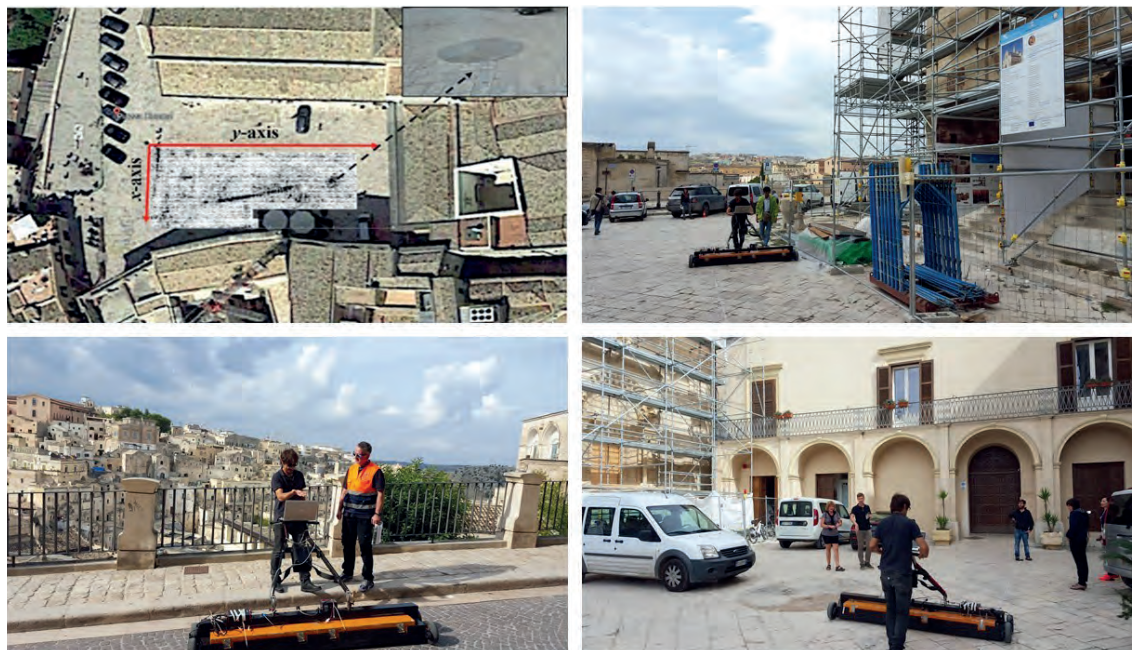
Fig. 2 - Immagini relative all'acquisizione delle misure georadar con il Sistema IDS Stream-x in piazza Duomo. In alto a sinistra, sovrapposizione di una constant depth slice tomografica all'immagine della piazza.
