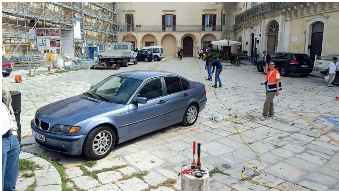
Fig. 3 - Immagine che riporta la fase di acquisizione delle misure geoelettriche; i picchetti sono stati posizionati lungo un grigliato indicato dai cavi gialli.
