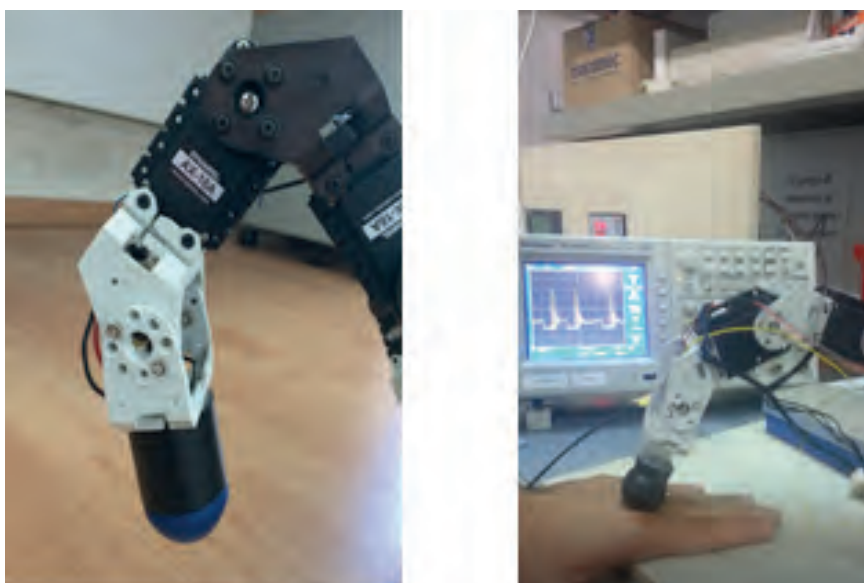
Fig. 4 - Particolare del sensore di pressione montato sulla tibia e sua caratterizzazione.
