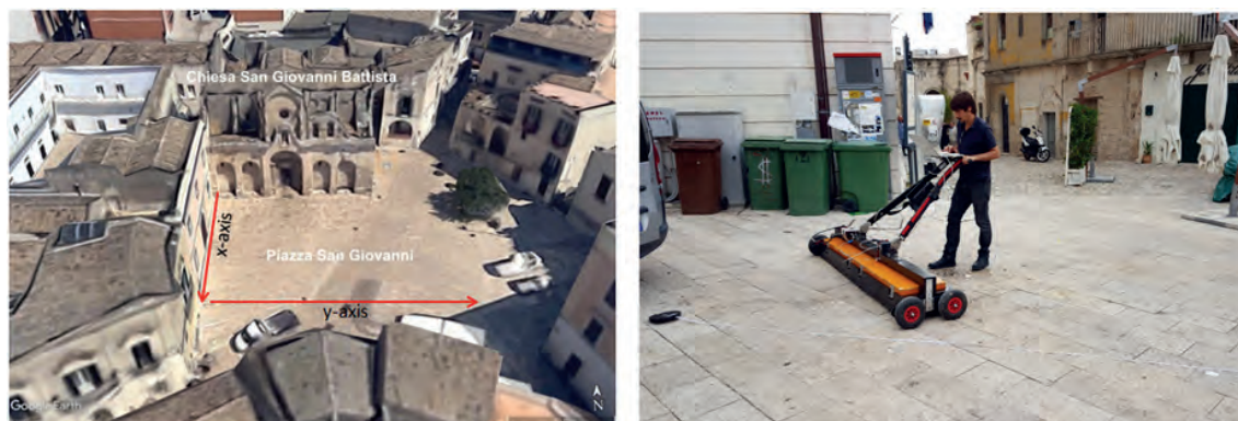
Fig. 4 - Acquisizione dati georadar in Piazza San Giovanni a Matera.
