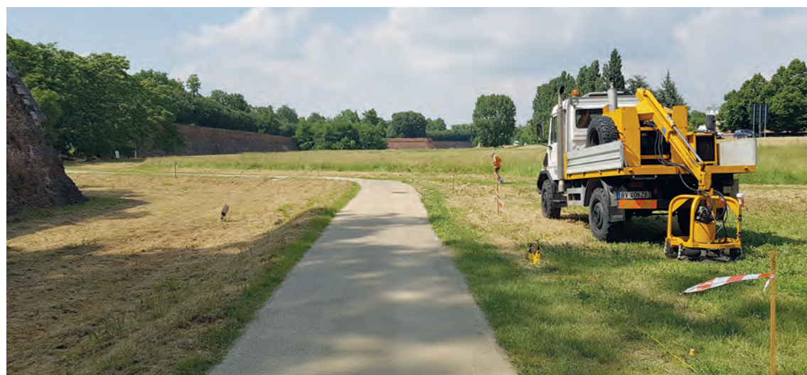
Fig. 2 - Particolare dello stendimento di geofoni della linea sismica a riflessione (onde P) e della sorgente vibroseis (MiniVib T-2500) in corrispondenza dell'estremità meridionale del profilo sismico.
