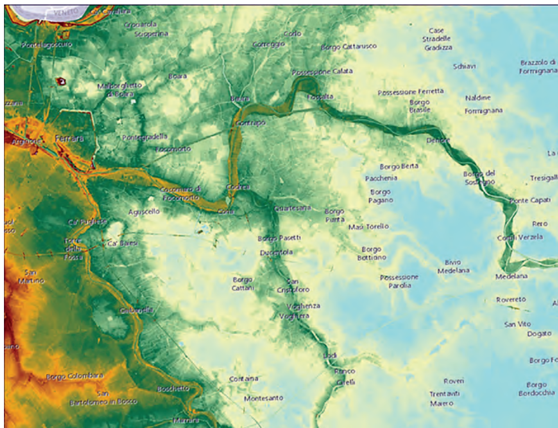
Fig. 1 - Modello altimetrico che mostra chiaramente l'espressione morfologica dei corpi sedimentari fluviali, ad oriente di Ferrara. Le tinte altimetriche di toni azzurri indicano quote fra -1 e +1 m rispetto al livello del mare, la gamma cromatica poi descrive quote crescenti, fino al marrone scuro, che individua aree fra +9 e +10 m. Ben visibile è il tracciato del medievale del Po di Volano, che scorre da Ferrara, per Fossalta, verso Medelana; da esso si stacca verso sud il dosso del coevo Po di Primaro, che serpeggia in direzione di Marrara. Il dosso più basso fra i due testimonia il principale corso di età classica, "Eridanus", abbassato dalla subsidenza.
