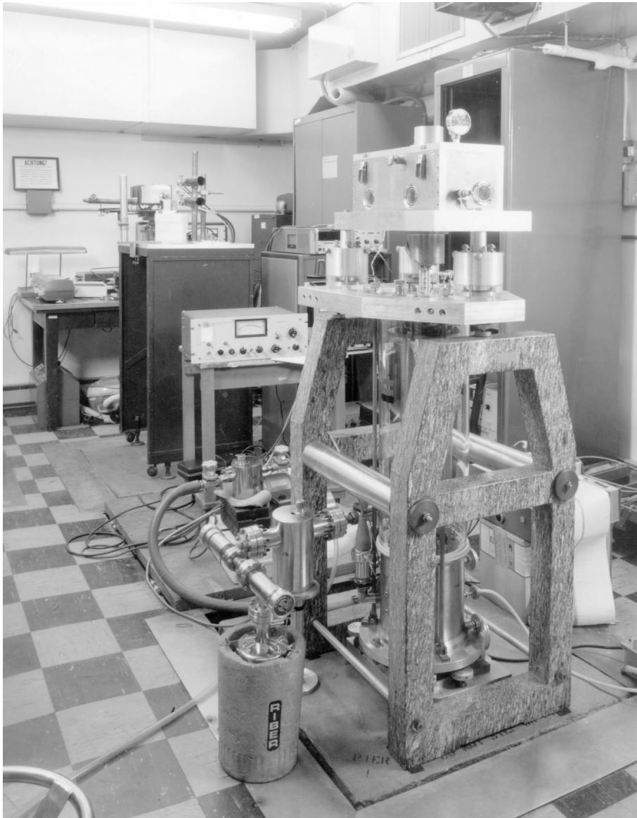
Fig. 4 - The Sakuma-Colonnetti transportable absolute apparatus (Cerutti et al., 1974).
